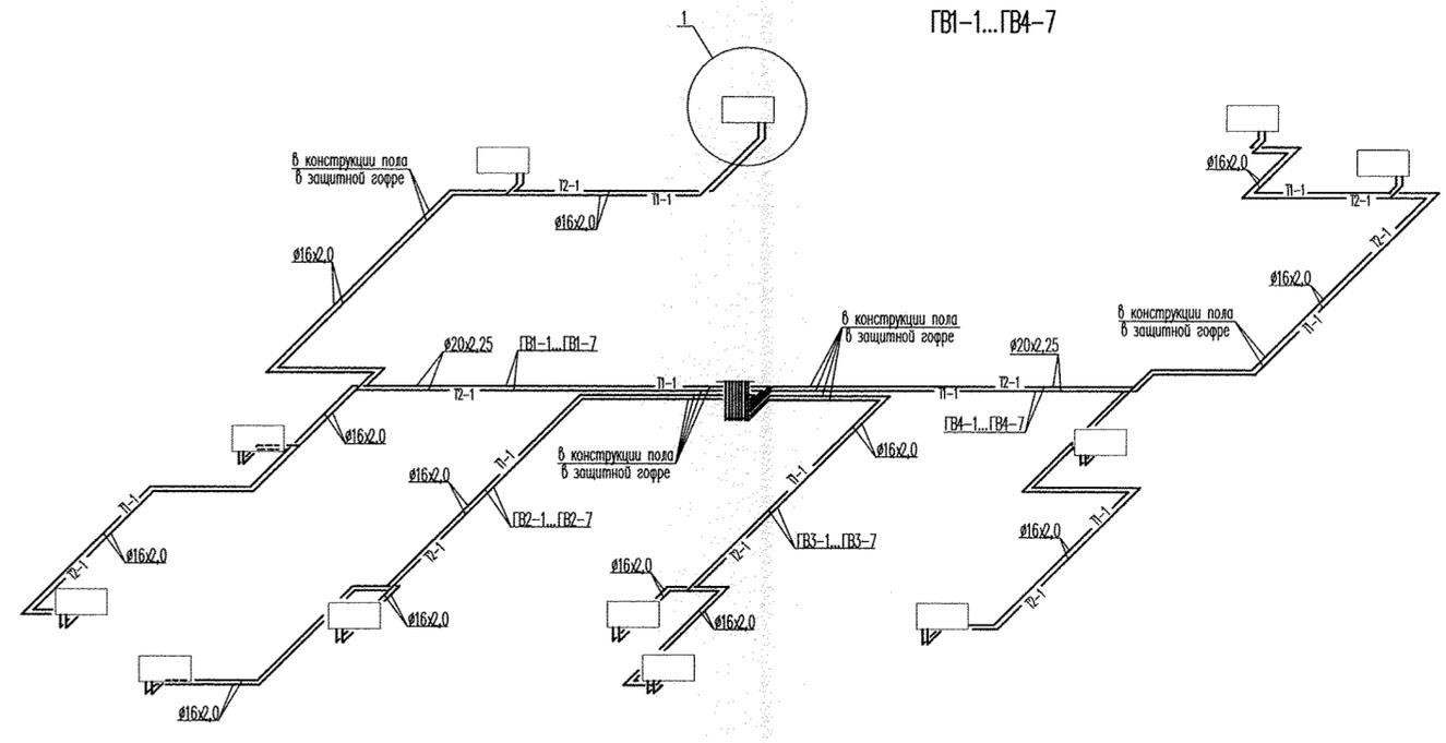
Схема системы отопления техполюля
