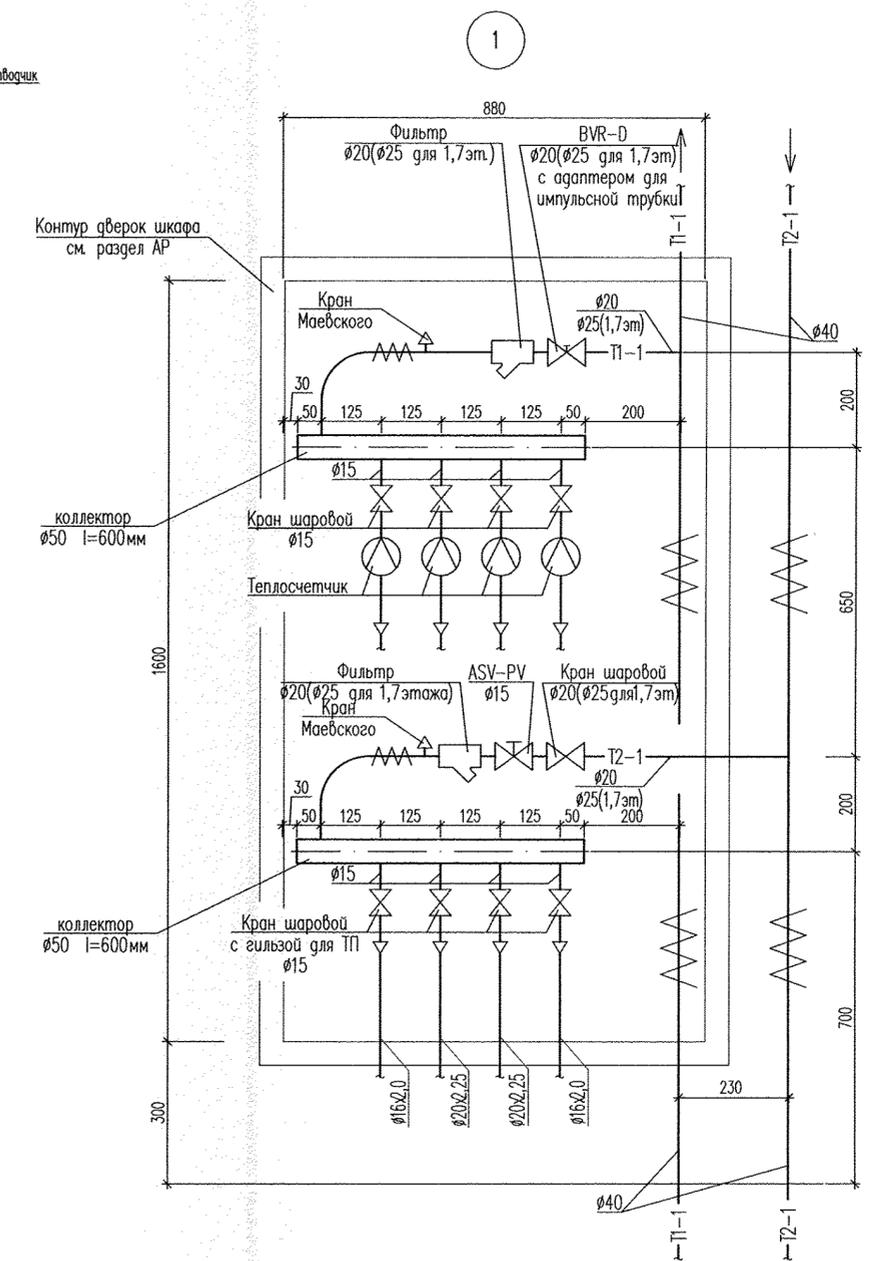
Предварительная настройка балансировочных клапанов
